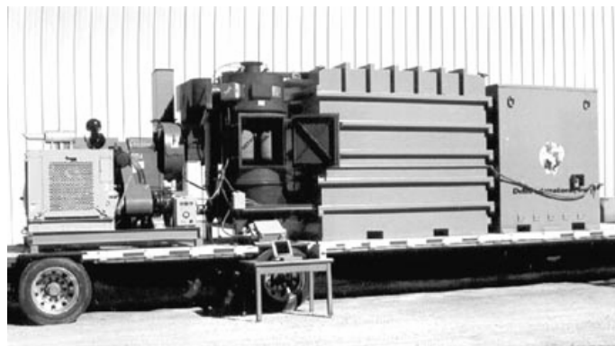
Donovan взривна камера - Donovan blast chamber (DBC) Издържа натоварване от взрива на заряд с маса до 5,5 kg
